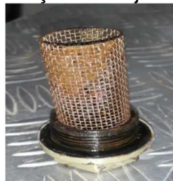
Figura 4 – Filtro da tubulação de água gelada
