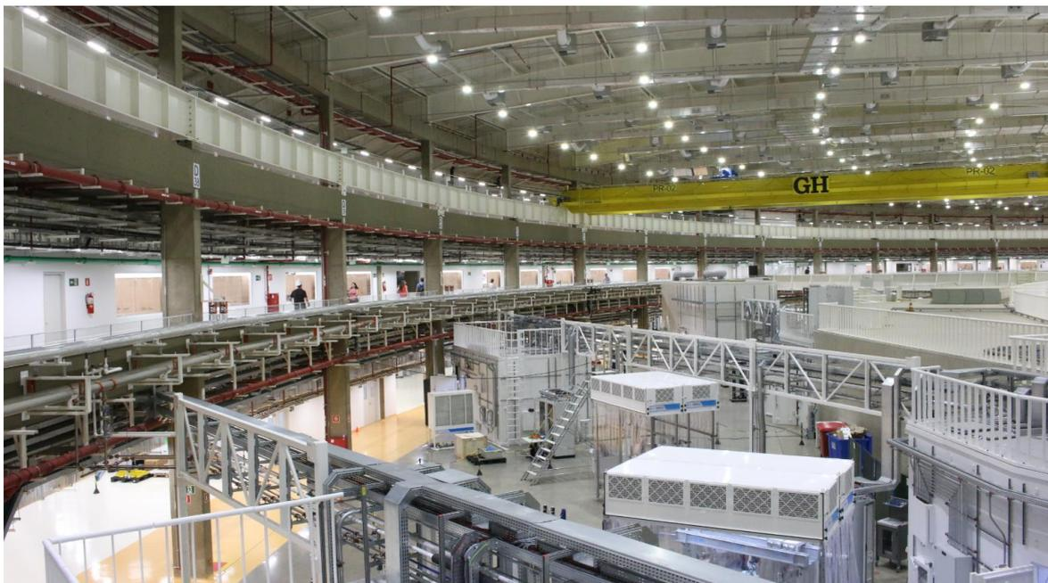
**Figura 4: Linhas de luz exemplo (Cabanas pesadas + Pipes + Cabanas leves)**
