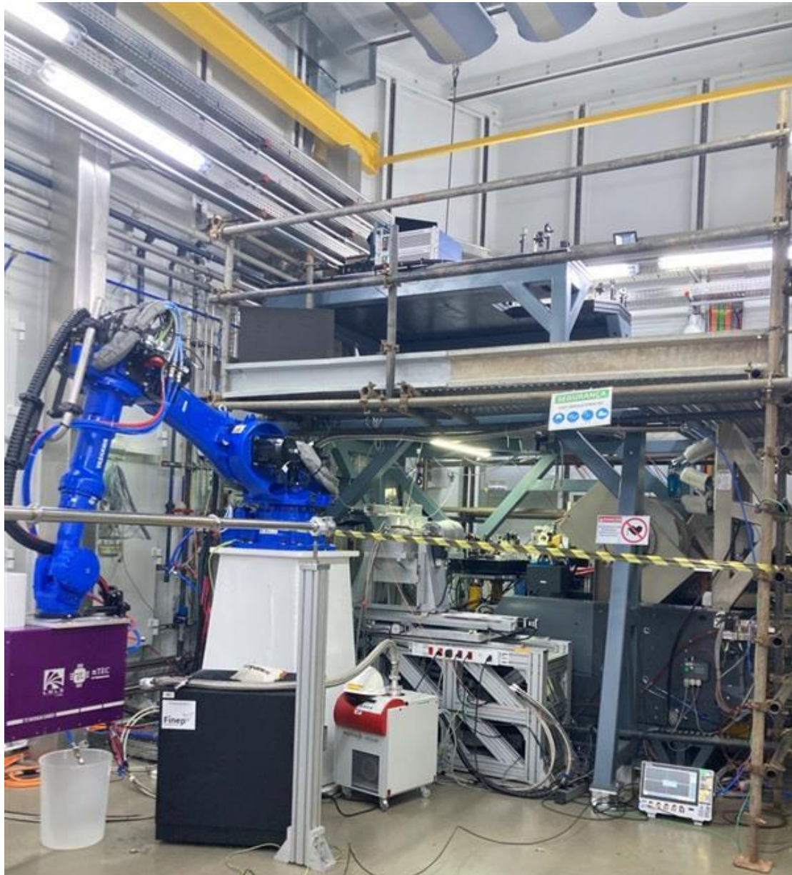
Figura 2 - Andaime montado na linha EMA
