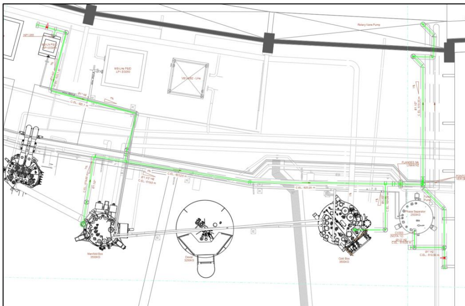
Figura 4: Vista superior da blindagem com a linha de exaustão de nitrogênio.
