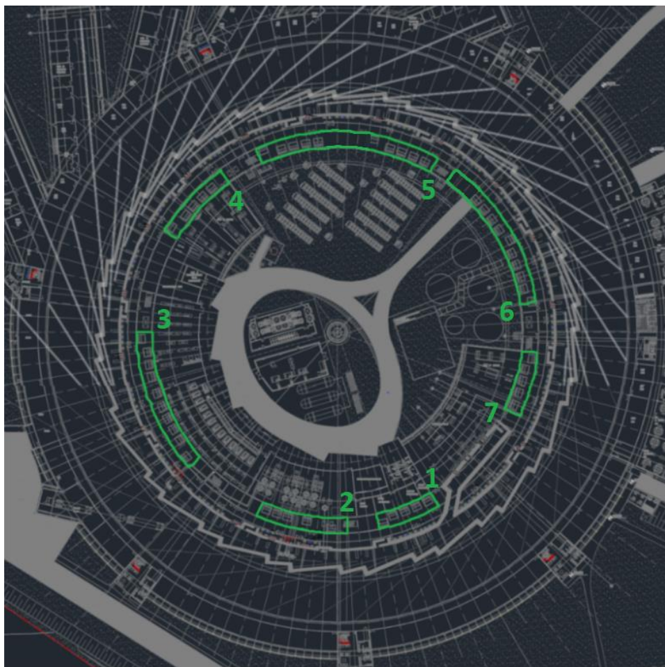
Figura 2. Localização das casas de máquinas.
