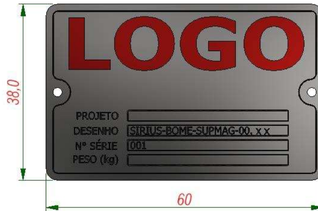
Figura 9 – Dimensional e layout da placa de identificação dos suportes.
