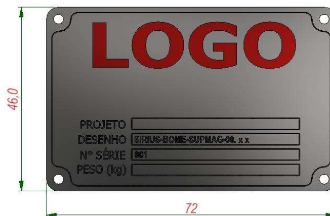
Figura 10 – Dimensional e layout da placa de identificação dos berços.
